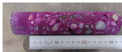
図3 被覆材コアの中酸化状況
